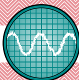
ANTES Ruido eléctrico sobre la onda senoidal
